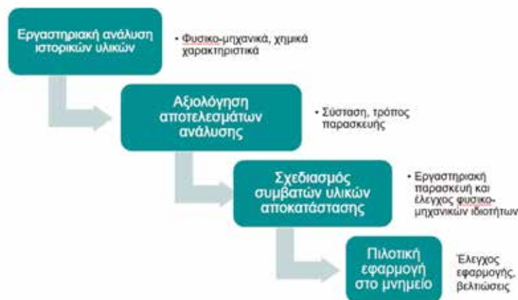
Εικ. 4. Σχηματική αναπαράσταση μεθοδολογίας σχεδιασμού κονιαμάτων επέμβασης
